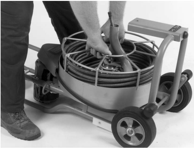
Figura 11 – Levante el tambor de su posición de montaje
