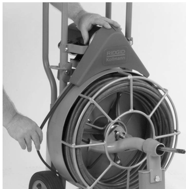
Figure 9 – Soulager la tension de la courroie
