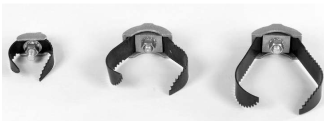
Figura 4 – Cortadoras T-411 de 2", T-413 de 3" y T-414 de 4": se usan en general para extraer las raíces de árboles y materiales adheridos a las paredes del desagüe
