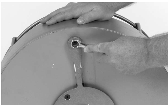
Figure 12 – Dépose du boulon de retenue de la queue de cochon
