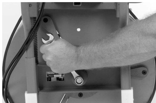
Figure 10 – Enlever le boulon de montage du tambour
