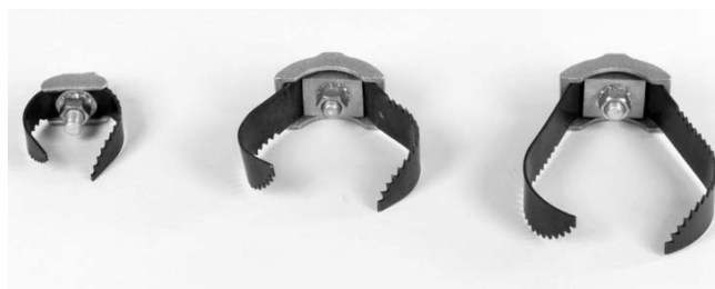
Figure 4 – Mèches de curage T-411 (2"), T-413 (3") et T-414 (4") pour curage général et élimination des racines d'arbre et autres matériaux accrochés aux parois des canalisations
