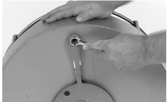
Figura 12 – Extracción del perno de enclavamiento de la “colita de cerdo”
